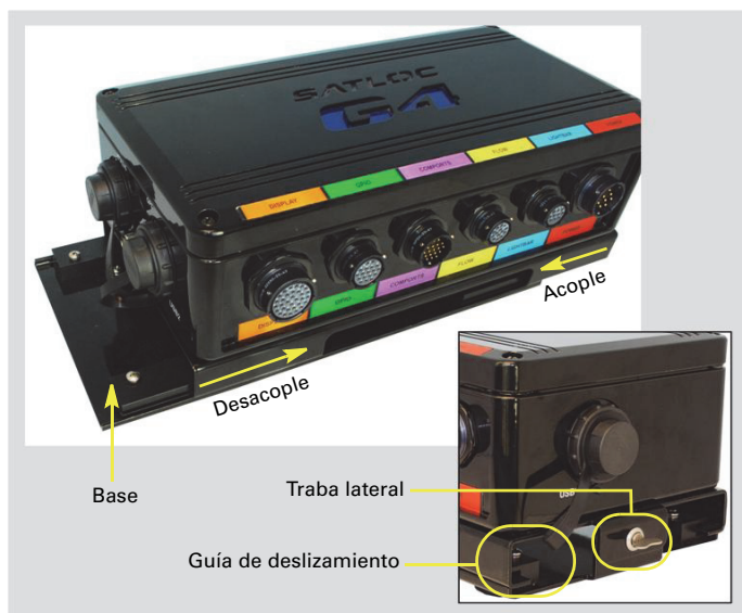
Figura 2-1: CPU en su bandeja deslizable de liberación rápida
