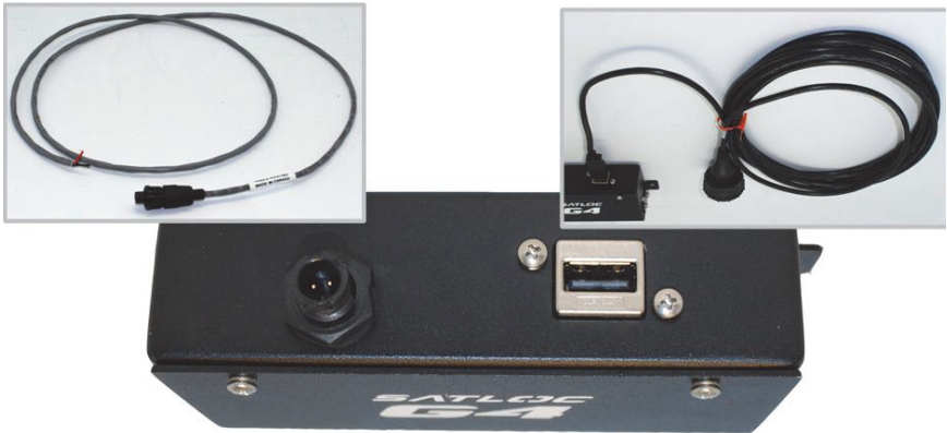
Figura 3-4: Multi-conector USB de 3 puertos con cables de alimentación y CPU
