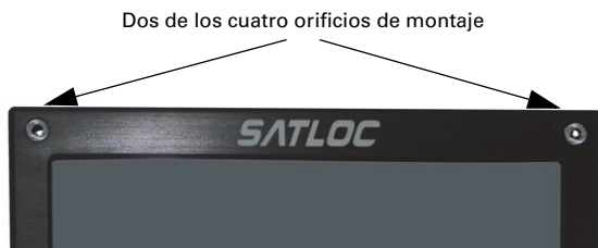
Figura 2-4: Orificios de montaje de la pantalla táctil
