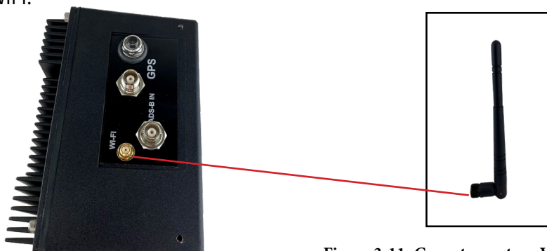
Figura 3-11: Conecte a antena WIFI à CPU Falcon
