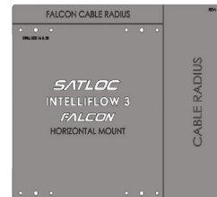
Figura 2-1: PN 601-1317-000 (Opcional, Disponível para compra) Modelo de layout de montagem para Falcon/IF3 Montagem horizontal (consulte o Apêndice C para obter a referência das dimensões.)
