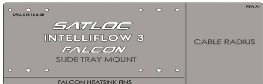
Figura 2-1: PN 601-1313-000 (Opcional, disponível para compra) Modelo de layout de montagem para montagem em rack Falcon/IF3 (Consulte o Apêndice C para referência de dimensões.)
