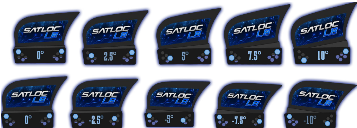
Figura 2-4: Ângulos de inclinação da barra de luzes L8
