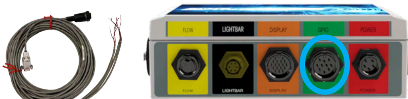
Figura 3-5. Cable GPIO (PN 051-0244-000#) al puerto GPIO de la CPU del Bantam 2 Cable GPIO (PN 051-0244-000#) al puerto GPIO de la CPU del Bantam 2
