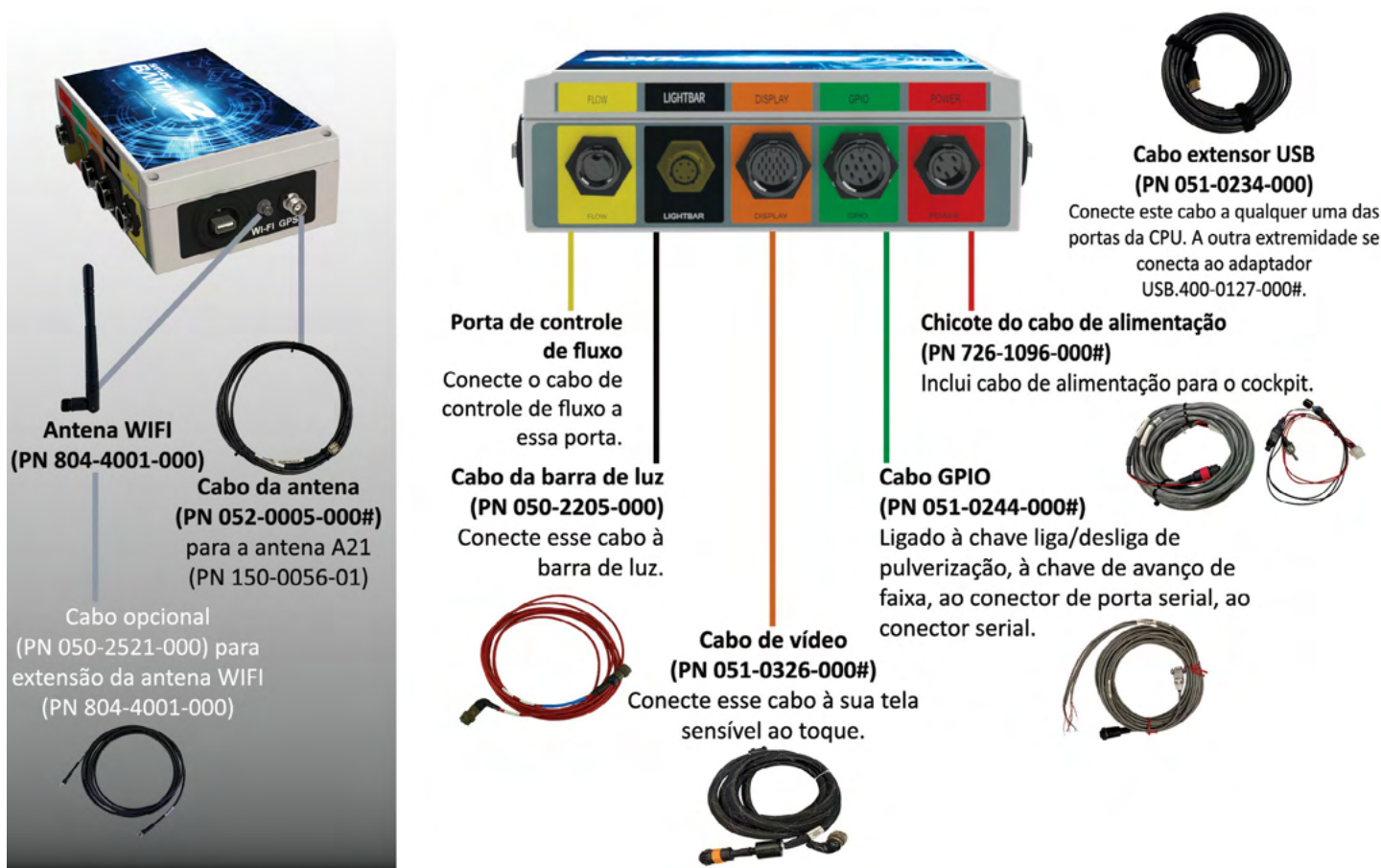
Figura 3-1: Conexões de cabos para a CPU Bantam 2
