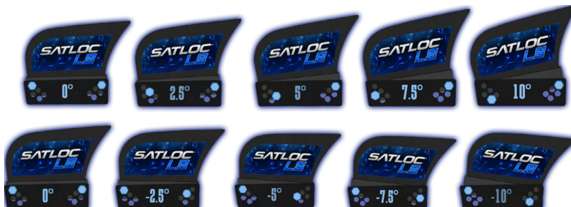
Figura 2-2: Ângulos de inclinação da barra de luz L8
