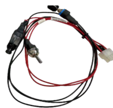
Figura 3-7: Painel de energia para o cockpit
